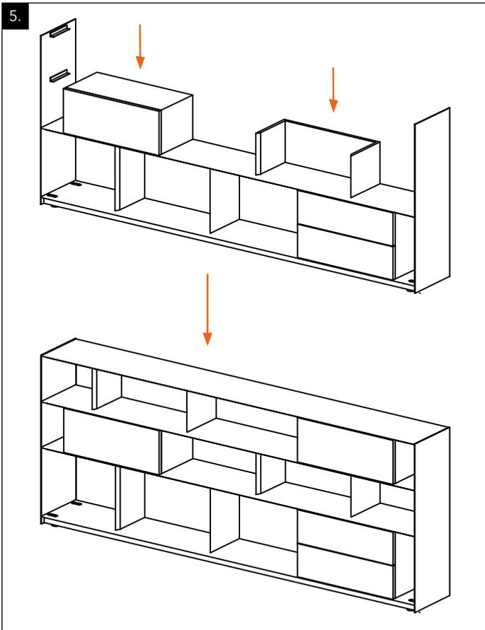
[DE] Nun die nächste Ebene (siehe Pkt. 3) mit den Einbauelementen bestücken. Den Zwischenboden aufsetzen (siehe Pkt. 4) und von der Unterseite mit 2 Blechschrauben fixieren.
