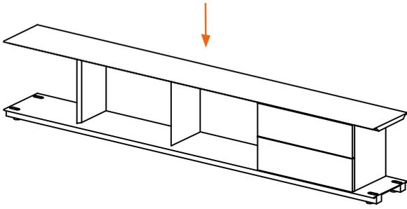
[DE] Setzen Sie nun den ersten Zwischenboden auf die Module.
