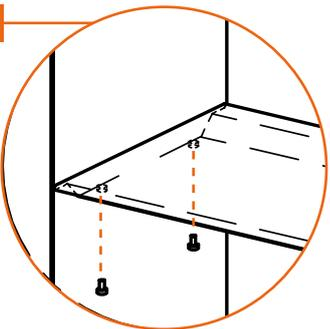
[DE] Setzen Sie nacheinander die Seitenteile an und verschrauben Sie diese mit jeweils 2 Blechschrauben an der Oberseite der Bodenplatte (A) und 2 Blechschrauben an der Unterseite des Zwischenbodens (B).
