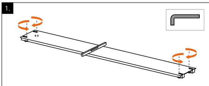
**[DE]** Legen Sie die Bodenplatte an den vorgesehenen Standort und richten Sie diese mit Hilfe der höhenverstellbaren Füße aus. Justieren Sie die Stellschrauben mittels Inbus und prüfen Sie die Ausrichtung mit einer Wasserwaage.
