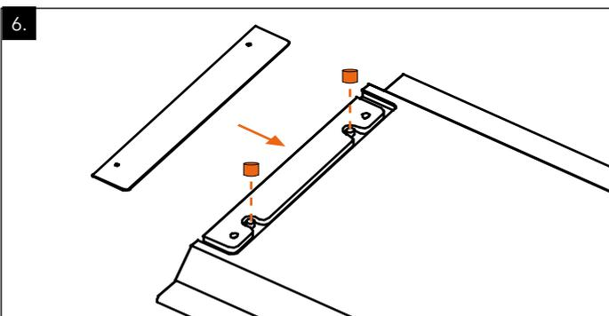
[DE] Abschließend setzen Sie die Abdeckplatten mit Hilfe der Magnete in die Aussparungen an der Unterseite der Zwischenböden ein. Die Abdeckung für die Aussparung an der Oberseite der Bodenplatte wird nur eingelegt. Zur Entnahme der Abdeckung Magnete verwenden.
