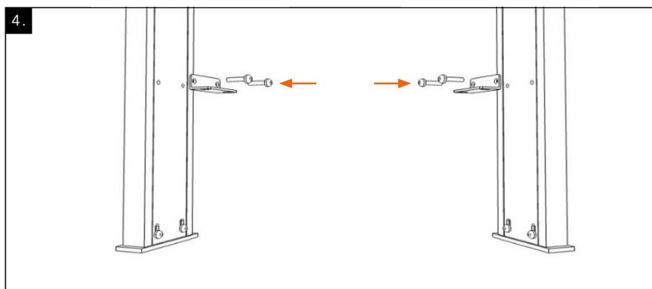
Die Winkel sind passend zum Fachboden bzw. zur Box lackiert. Die entsprechenden Winkel beidseitig an die gewünschte Position montieren und dabei die Schrauben fest anziehen.
