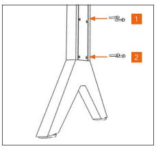
Alle 4 Schrauben (1) und (2) fest verschrauben, sofern auf den beiden untersten Ebenen kein Fachboden/Box vorgesehen ist.
