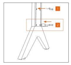
Achtung: Für den Einbau eines Fachbodens/ Box auf unterster Ebene den Winkel mit den beiden unteren Schrauben (2) montieren.
