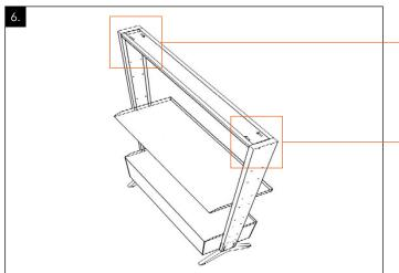
**Quertraverse montieren:** Die Quertraverse als vertikaler Abschluss mit 2 Schrauben auf jeder Seite <u>fest verschrauben.</u>
