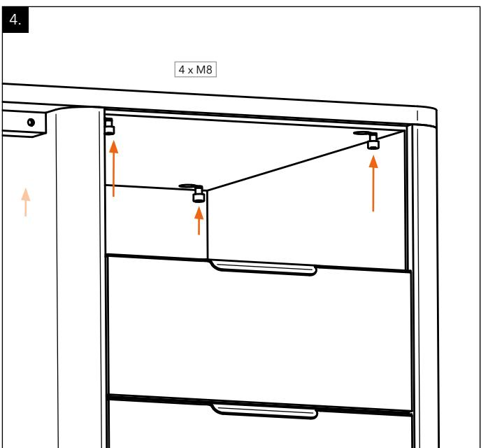
[DE] Die 4 x M8 Schrauben von unten festziehen, um die Platte zu fixieren. Zuletzt Schublade wieder einsetzen und mit den beiden Schrauben plus Kontermuttern befestigen.
