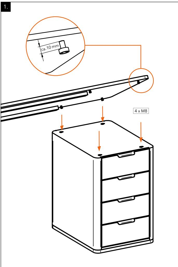
[DE] Die 4 Gewindeschrauben M8 bis auf einen Abstand von ca. 10 mm aus dem Gewinde der Arbeitsplatte herausdrehen. Nun die Platte so auf den Container auflegen, dass die Gewindeschrauben in die gestanzen Löcher auf der Oberseite des Containers einrasten.
