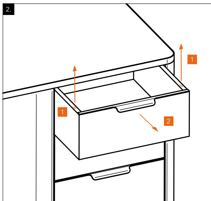
[DE] Nun die obere Schublade herausnehmen: Dazu die beiden Schrauben inklusive Kontermuttern entfernen und die Schublade von der Laufschiene ziehen.
