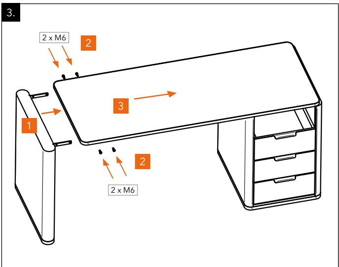
[DE] Die Seitenwange in die Verstrebung auf der Unterseite einschieben und mit den 4 Gewindeschrauben M6 fixieren. Nun die Platte nach rechts schieben, sodass die Platte bündig auf dem Container aufliegt.
